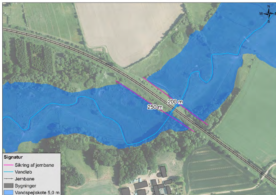
Figur 4-8 Etablering af diger til sikring af baneskråning.
