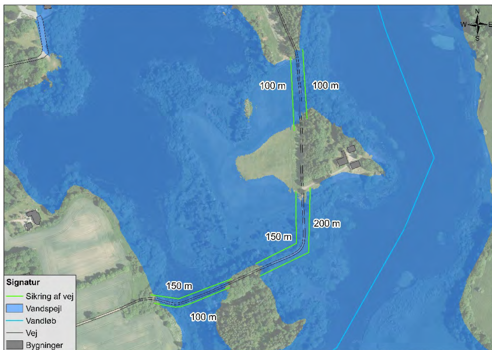
Figur 4-33 Der kan være behov for sikring af Koldingvej gennem den opstemmede Sønder sø.
