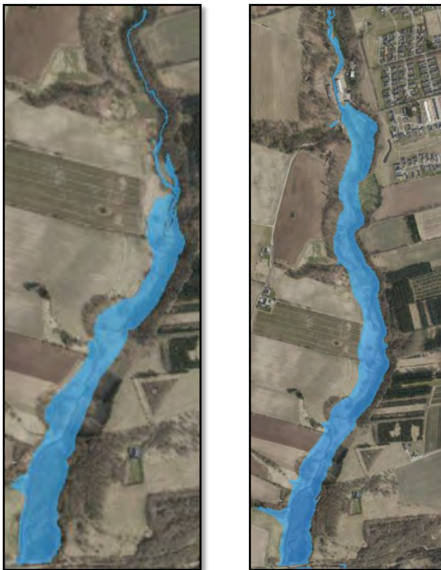
Figur 4-23 Udbredelsen af stuvning i Vester Nebel Å for hhv. kote 27(tv) og kote 30(th).
