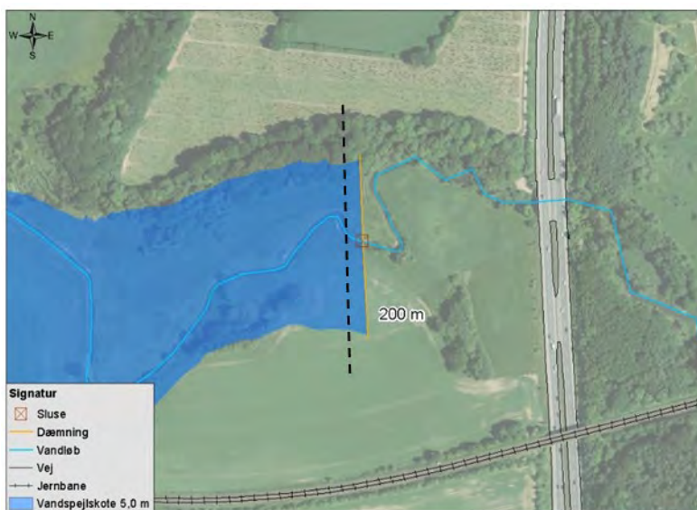
Figur 4-6 Visning af tværsnit-placering over ådalen svarende til hvor dige og sluse kan etableres. Den endelige placering kan indpasses efter landskabets konturer og evt. flyttes nærmere motorvejsbroen.
