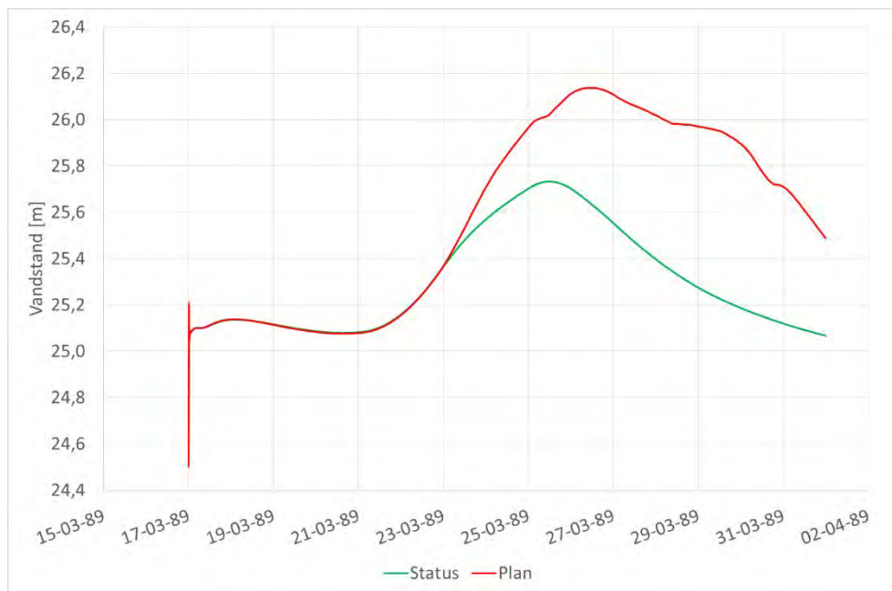
Figur 6-6 Vandstand i magasin ved Stallerup Sø For status samt for plan situationen (E45 + Dons).
