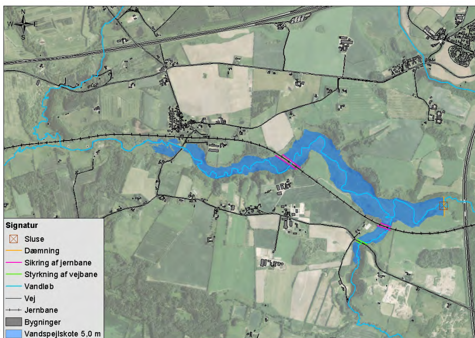
Figur 4-4 Udstrækning af vandspejl svarende til stuvning til kote +5,00 m i Ådalen vest for E45
